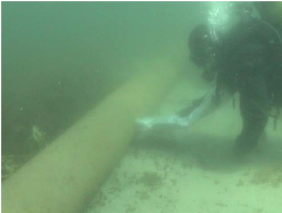
Проведение замеров электромагнитного поля кабеля в водной среде, показания замеров на различных подводных участка кабельных цепей.
