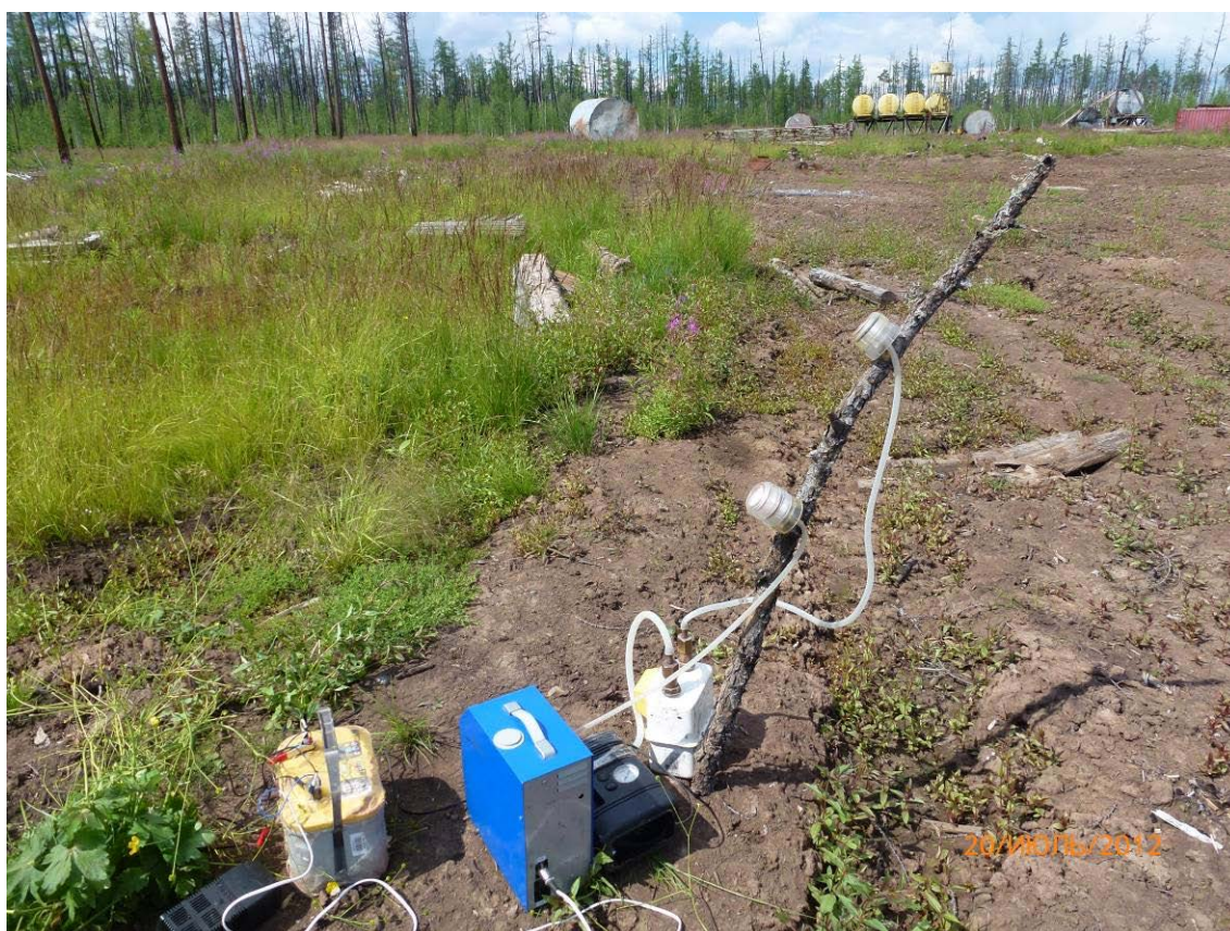
Проведение отбора проб атмосферного воздуха, наветренная сторона площадки скважины 11 (Большетирский ЛУ)
