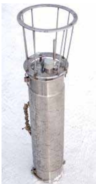
Автономный гидроакустический измеритель толщины льда для мониторинга ледового покрова (слева), гидрофоны со встроенными усилителями и автономным питанием (справа).
