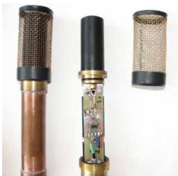
Автономный гидроакустический измеритель толщины льда для мониторинга ледового покрова (слева), гидрофоны со встроенными усилителями и автономным питанием (справа).
