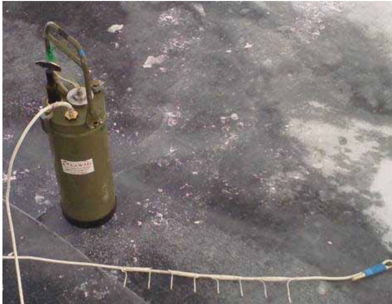
Термисторные косы для регистрации вертикального распределения температуры во льду и верхнем слое воды.
